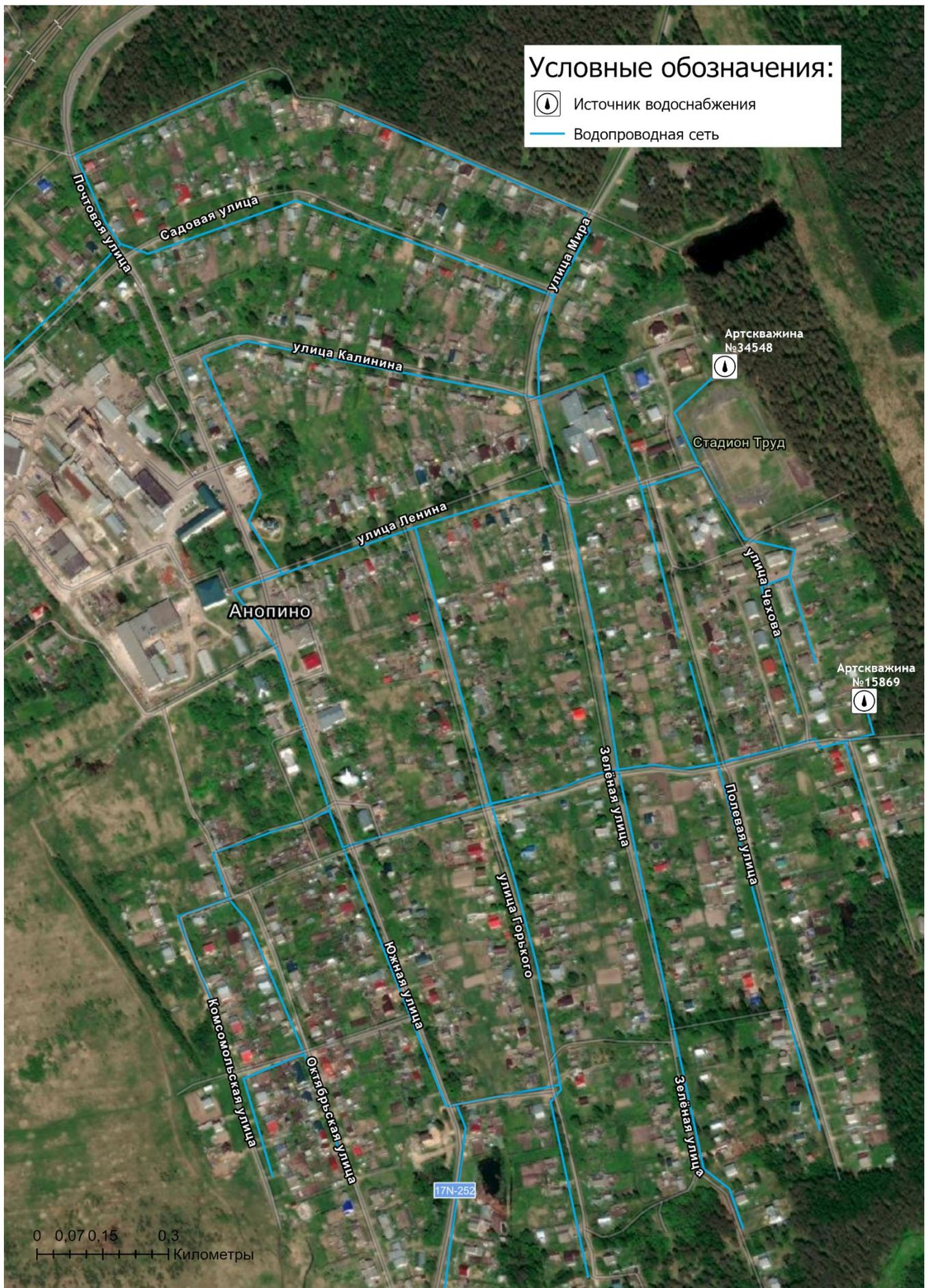
Рисунок 7.1 - Схема водоснабжения пос. Анопино
