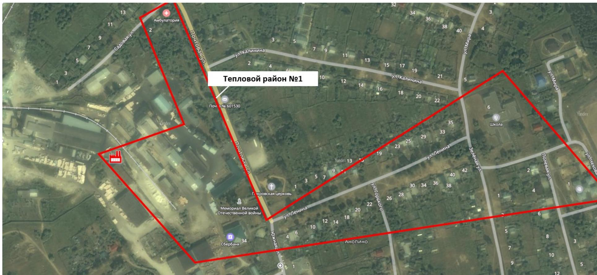
Рисунок 1.1.2 - Зона центрального теплоснабжения, существующая схема теплоснабжения от котельной ООО «Экспо Гласс»
