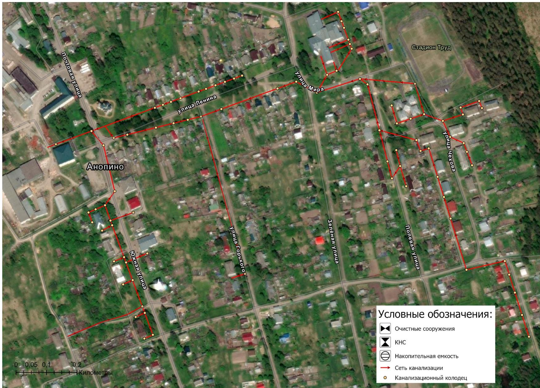
Рисунок 8.1 - Схема водоотведения пос. Анопино
