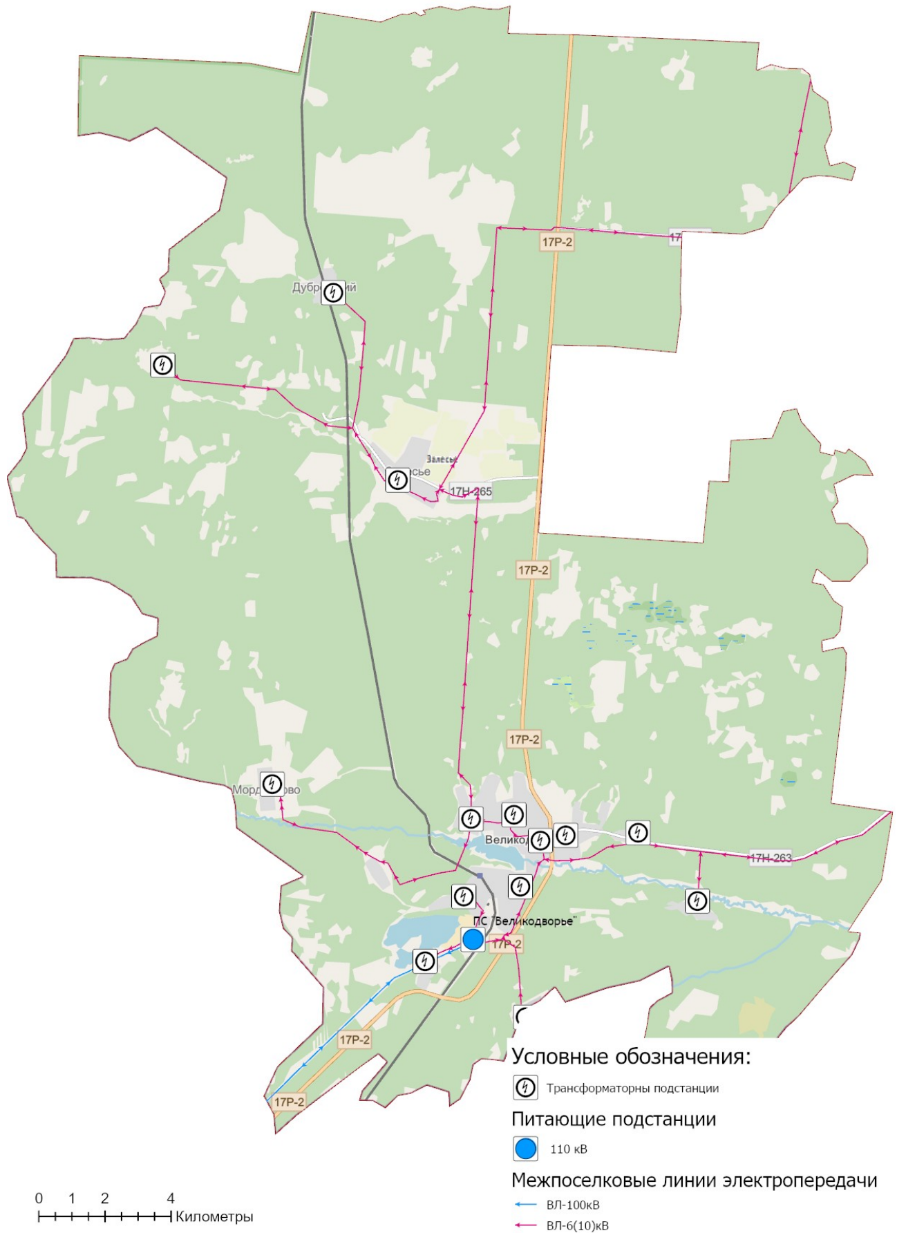
Рисунок 5.1 - Схема электроснабжения МО пос. Великодворский сельское поселение
