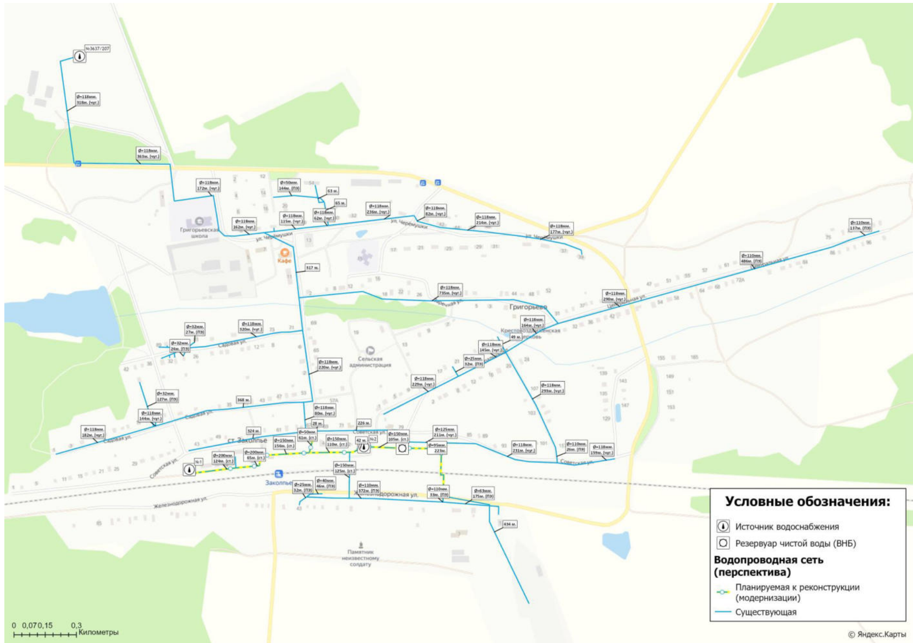
Рисунок 4.8.3 - Схема прохождения реконструируемых (модернизируемых) участков водопроводных сетей на территории с. Григорьево
