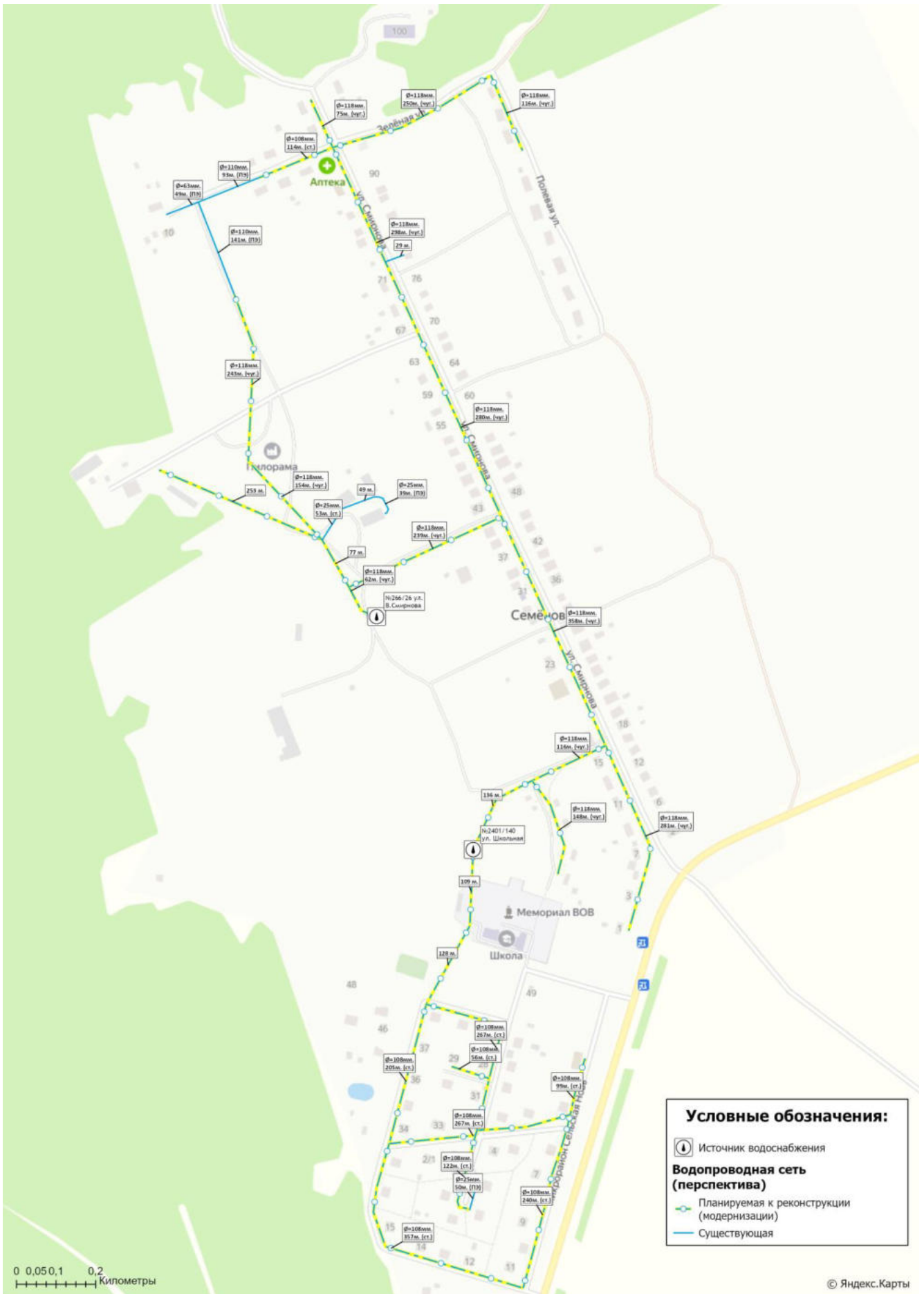
Рисунок 4.8.1 - Схема прохождения реконструируемых (модернизируемых) участков водопроводных сетей на территории д. Семеновка
